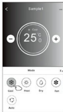
*Hinweis: Im Entfeuchtungsmodus kann die Temperaturanzeige der APP in den ersten 3 Minuten geringfügig von der Geräteanzeige abweichen, da sich die Gerätetemperatur schnell ändert.*
